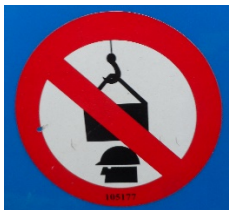
Verbotszeichen an einem Kran, sich unter einer schwebenden Last aufzuhalten. (Zl: SAM_2070)
