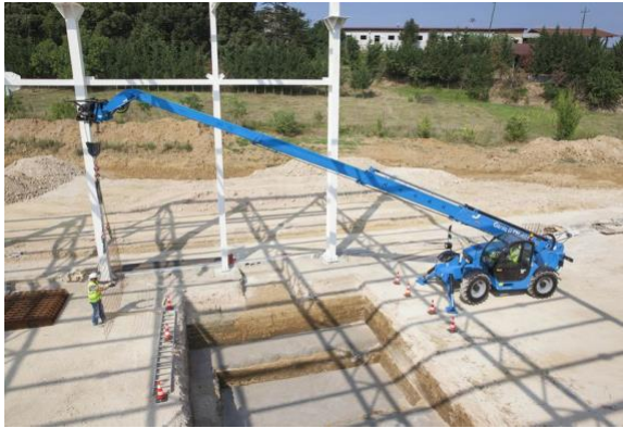
Große Reichweiten sind für den Teleskopstapler kein Problem. Nicht zuletzt deswegen ist er auf Baustellen so beliebt (Genie).
