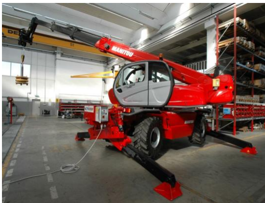
Für das Arbeiten in geschlossenen Räumen stehen Maschinen mit einem Elektromotor zur Verfügung (Manitou).
