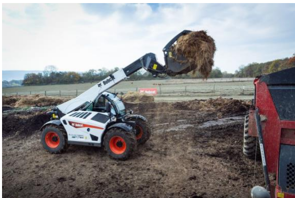
Teleskopstapler mit starrem, aber teleskopier-barem Ausleger: Die Einsatzmöglichkeiten der Maschine sind äußerst umfangreich (Bobcat).
