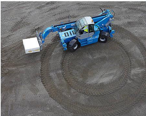
Wenn es einmal eng wird, ist das für den Fahrer meistens kein Problem. Dank der Allrad-Lenkung ist der Teleskopstapler äußerst wendig, wie dieses Foto beweist (Genie),.
