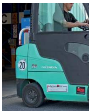
Abb. 7: Geschwindigkeitskennzeichnung und Halterdaten auf Stapler
