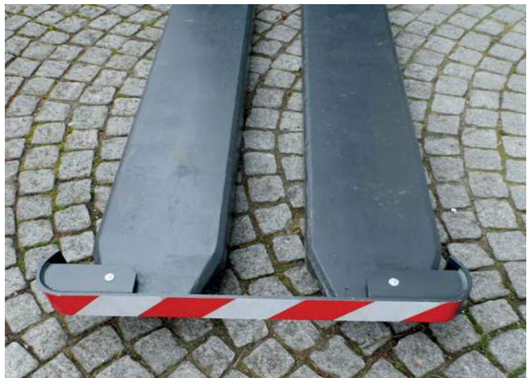
Abb. 12: Vorschriftenmäßige Gabelzinkenabsicherung für einen Stapler
