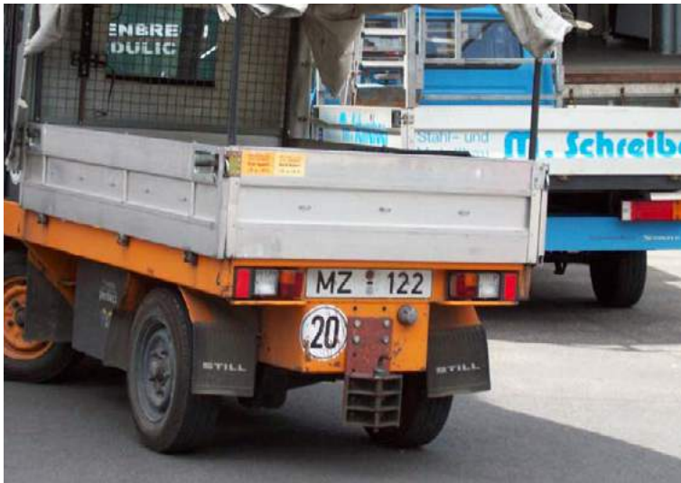
Abb. 8: Plattformwagen mit amtlichen Kennzeichen versehen – obwohl bauartbedingt auf 20 km/h begrenzt
