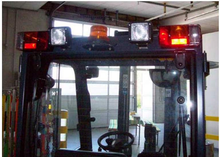
Abb. 11: Lichtanlage hinten nach StVZO am Fahrerschutzdach eines Staplers
