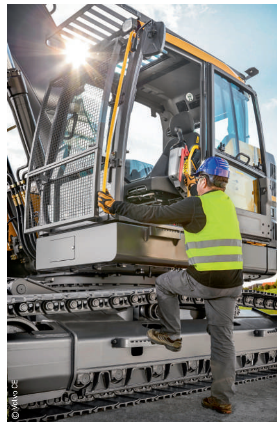
9 | Vorbildlicher Erdbaumaschinenführer mit Sicherheitsschuhen, Schutzhelm, Schutzhandschuhen und Warnkleidung
